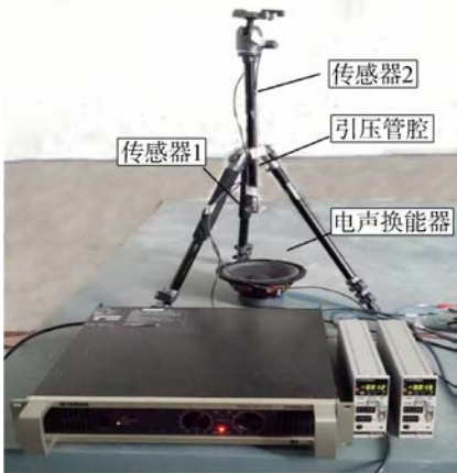
图 14 电声换能器正弦压力试验过程 Fig. 14 Electroacoustic transducer sinusoidal pressure test process
